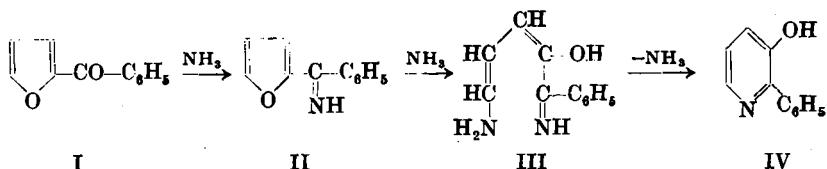
Danach entsteht aus dem Keton I zuerst das Ketimid II; der Furanring des Ketimids wird dann durch Ammoniak aufgespalten zu III, das dann durch Ringschluß in das 3-Oxy-2-phenyl-pyridin (IV) übergeht. Es wurden folgende Phenyl- $\alpha$ -furyl-ketone zu den 3-Oxy-2-phenyl-pyridinen (s. S. 203) umgesetzt:
